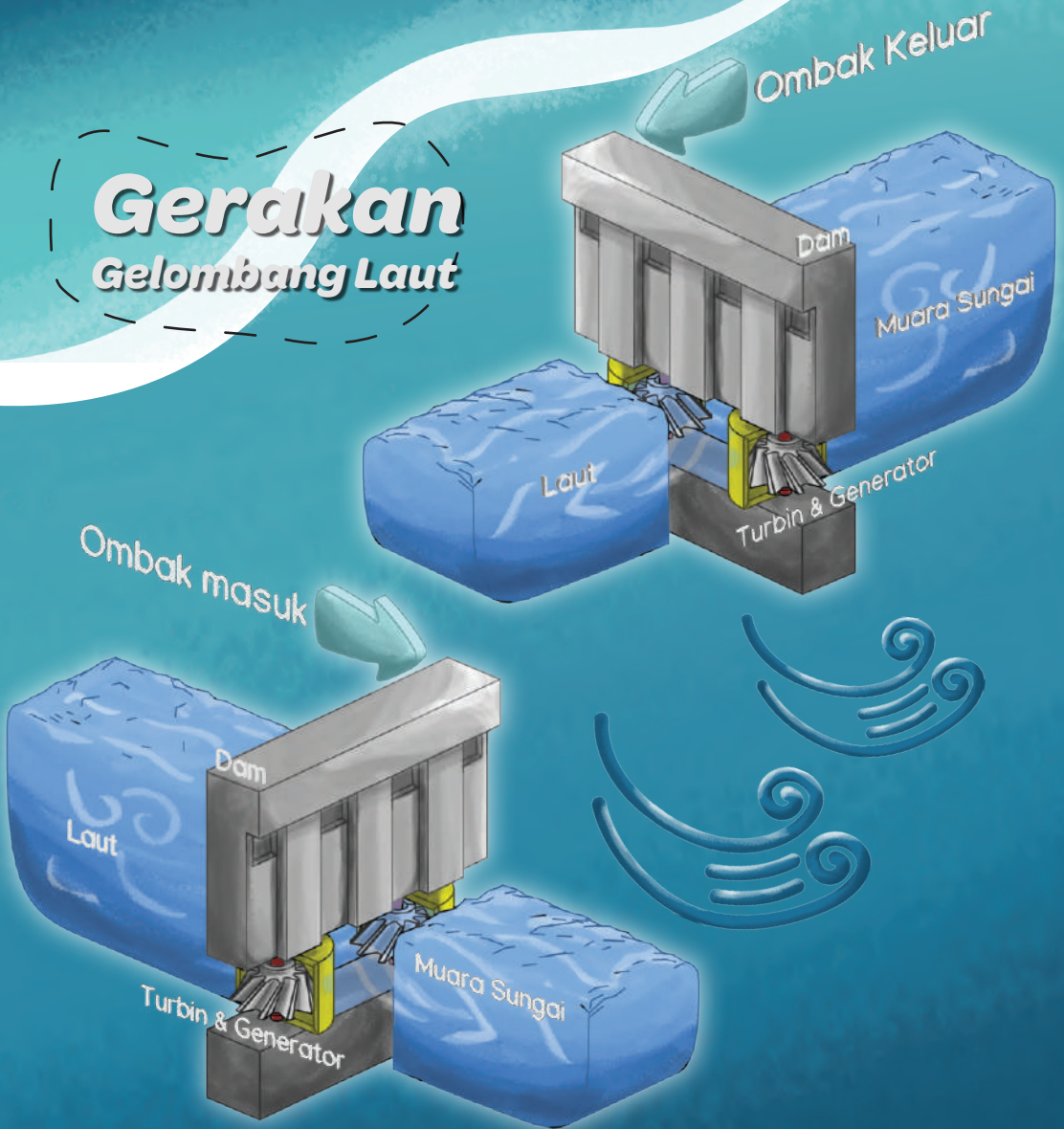
Ilustrasi 7. Cara kerja pembangkit listrik water column oscillations menggunakan gerakan gelombang laut (kiri) dan cara kerja pembangkit listrik bendungan pasang surut laut (kanan)
