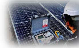
Inspeksi untuk mengidentifikasi masalah dalam sistem PLTS PV: pemeriksaan visual panel, inverter, dan struktur pemasangan, serta memantau kinerja sistem melalui analitik data untuk mendeteksi kinerja yang kurang baik atau malfungsi.
